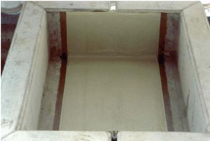
Prüfgefäß mit durchgängiger, ca. 3 cm breiter Fuge
