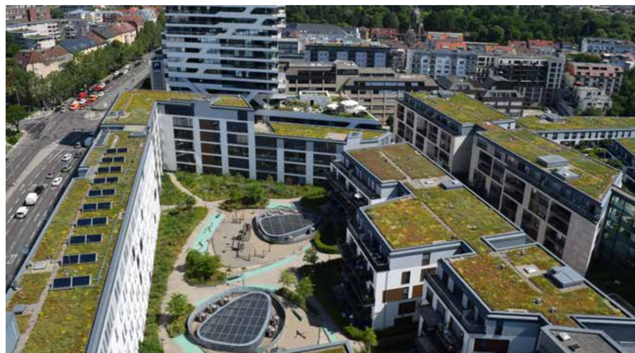
Abb. 14: In 2020 wurden 82,1 % Extensiv- (im Bild links und rechts) und 17,9 % Intensivbegrünungen (im Bild mittig unten und oben) ausgeführt. Quelle: BuGG
