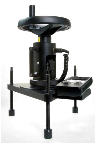
Beispiel eines Dübelauszugsgerätes mit digitaler Auswerteeinheit Lastbereich bis 15,0 kN
