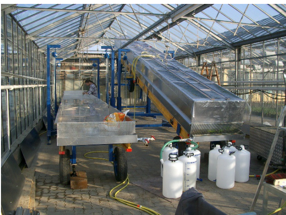
Abbildung 3: Versuchsanlage für Abflussmessungen bis 15 Grad Neigung höhenverstellbar
