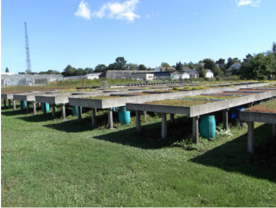
Abbildung 1: Versuchstische zur Messung der jährlichen Wasserrückhaltung/des Jahresabflussbeiwertes
