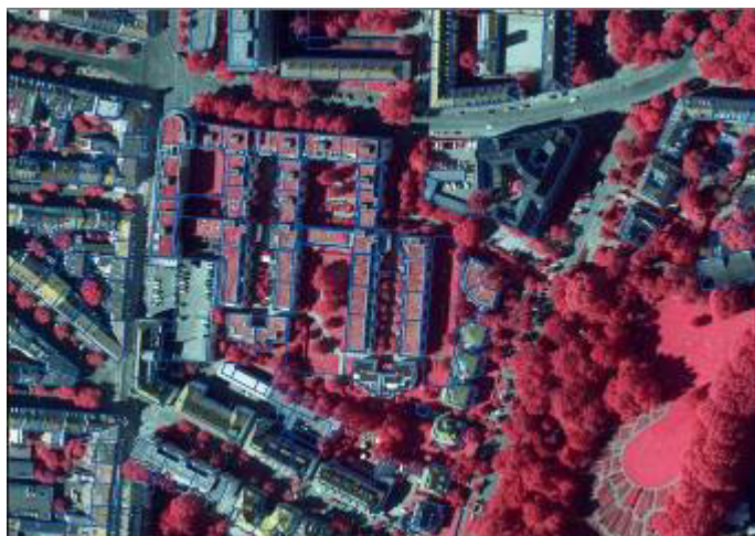
Abbildung 3: Um die Beschaffenheit der Dachoberflächen automatisiert zu ermitteln, werden verschiedene fernerkundliche Datensätze und Geoinformationsdaten miteinander verknüpft.
