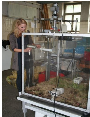
Abbildung 3.1-1: Messzelle mit ausgerichteten Partikelmessgeräten auf der Prüfvariante „unbegrünte Matte“ (links) und Applikation des Prüfstaubes (rechts).
