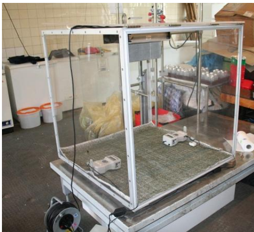
Abbildung 3.1-1: Messzelle mit ausgerichteten Partikelmessgeräten auf der Prüfvariante „unbegrünte Matte“ (links) und Applikation des Prüfstaubes (rechts).
