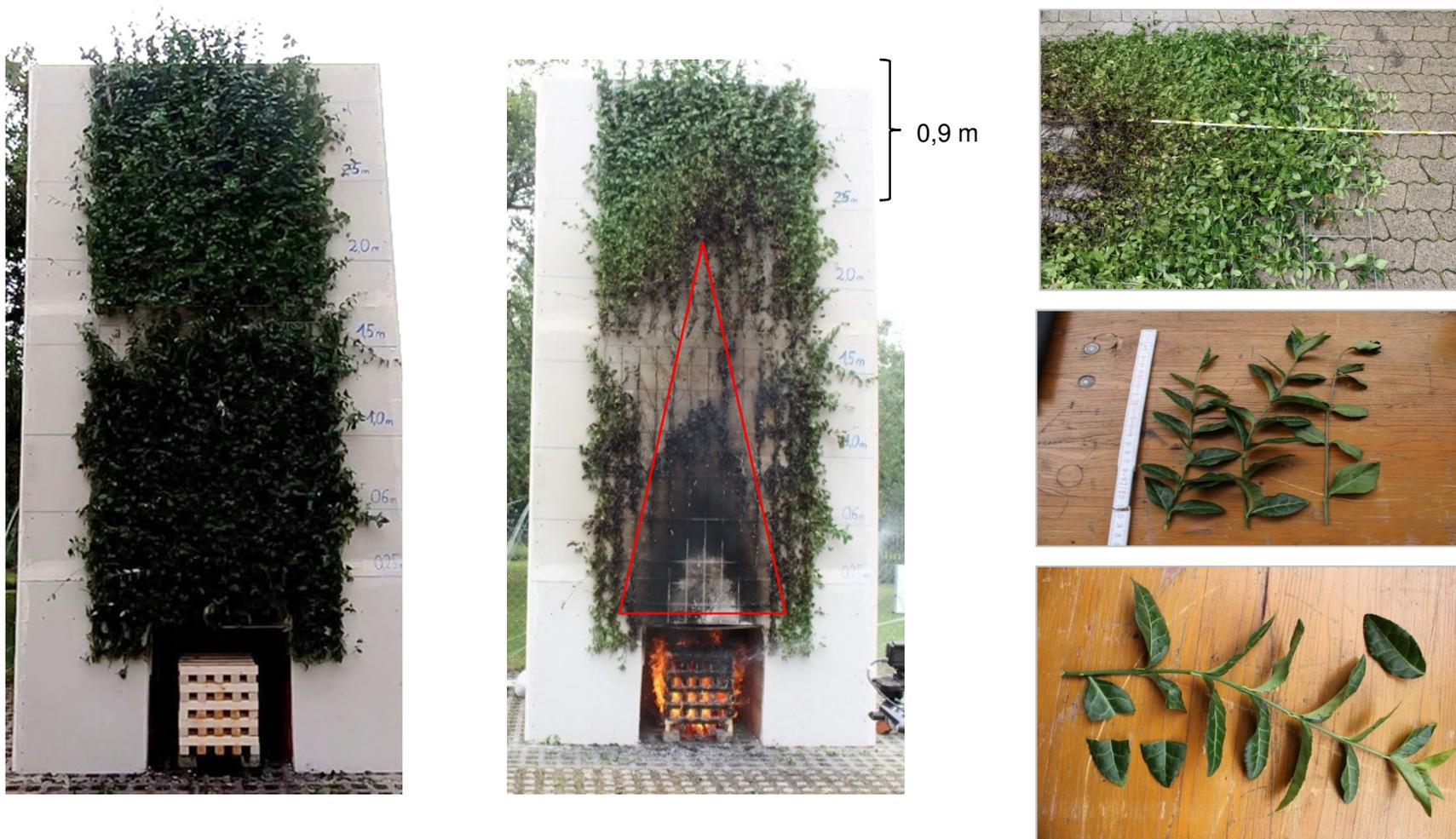
Abb. 30 bis 35: Brandversuch FA\_BV\_Kriechspindel
