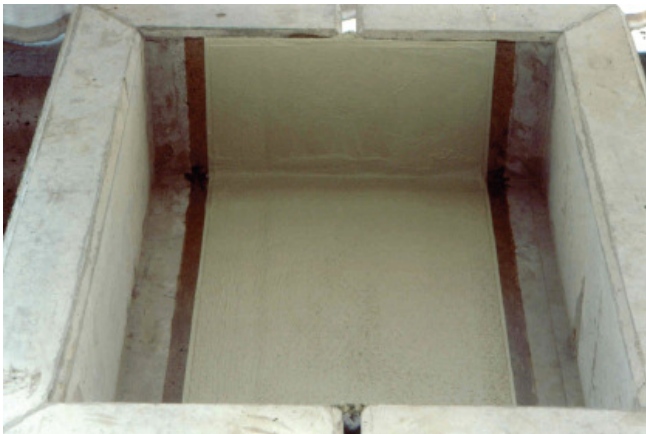
Prüfgefäß mit durchgängiger, ca. 3 cm breiter Fuge
